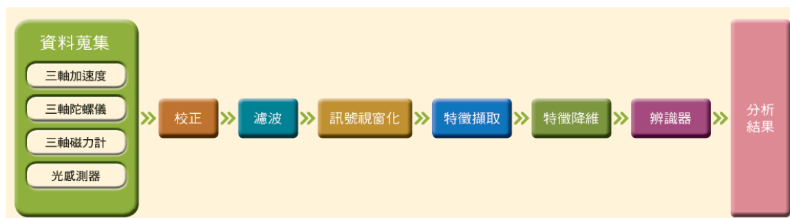
圖 9 感測元件量測的訊號分析流程圖[3]
