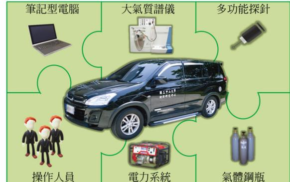
圖六 第四代可移動式（車載式）大氣質譜儀。
