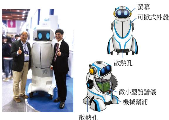
圖七 第五代可移動式快篩大氣質譜機器人於2019年於科技部所主辦的「未來科技突破展」中展示。
