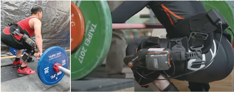
圖一：外骨骼機器人可以作為運動訓練中輔助和預防傷害的設備。在舉重動作帶來了正面的影響，在下肢膝關節穿戴外骨骼機器人後，膝關節角加速度提高 62.72%、膝關節淨反作用力降低 3.56% 受力，明顯的提升膝關節的運動表現，又能夠降低膝關節的負荷
