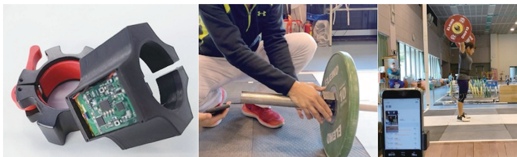
圖三：舉重鎖扣感測器記錄選手舉起槓鈴的資訊，提供教練進行技術指導。有效的幫助與優化訓練的過程，能夠精準的監控訓練品質和訓練成效，協助教練與選手不斷的打破紀錄
