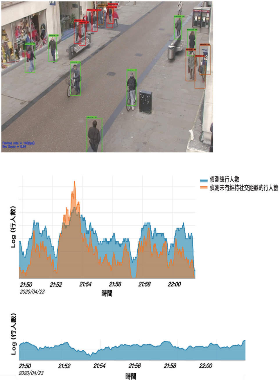
圖四：Neuralet 開源智能社交距離偵測系統。(上圖)：影像中的接觸行為判釋，紅框代表接觸距離過近，綠框則符合社交距離規範的閾值範圍。(下圖)：人群距離偵測系統的結果圖，藍色折線代表行人總數，橘色線代表距離過近（違反社交距離）的行人數。(圖中原文敘述經作者翻譯與後製)
