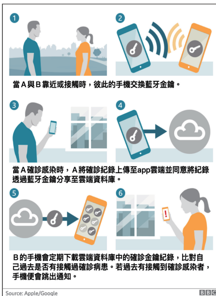
圖三：Apple 與 Google 共同開發的智慧型手機功能，透過藍牙來追蹤和串聯個人的接觸行為網絡。（圖中原文敘述經作者翻譯與後製） （圖片來源： https://www.bbc.com/news/technology-52246319 ）
