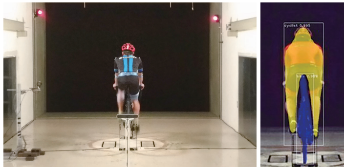
圖四：風洞自由車選手迎風面積量測示意圖
