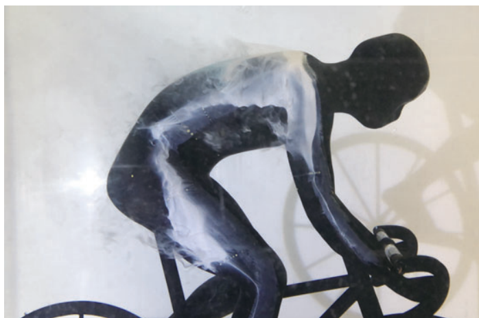
圖五：自由車手模型分離線位置示意圖
