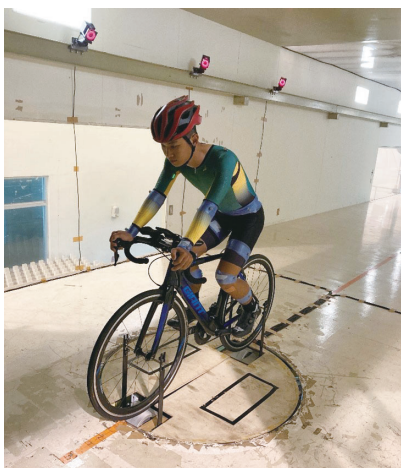
圖八：將粗糙原樣式3製作為實體車衣於風洞內進行實驗
