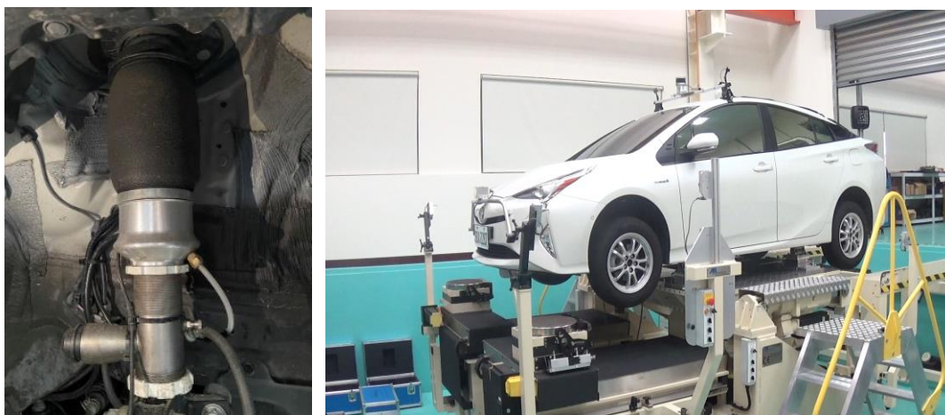
逢甲團隊研發之國產化氣/液壓式類主動懸吊系統，進行實車底盤 K&C 量測。
