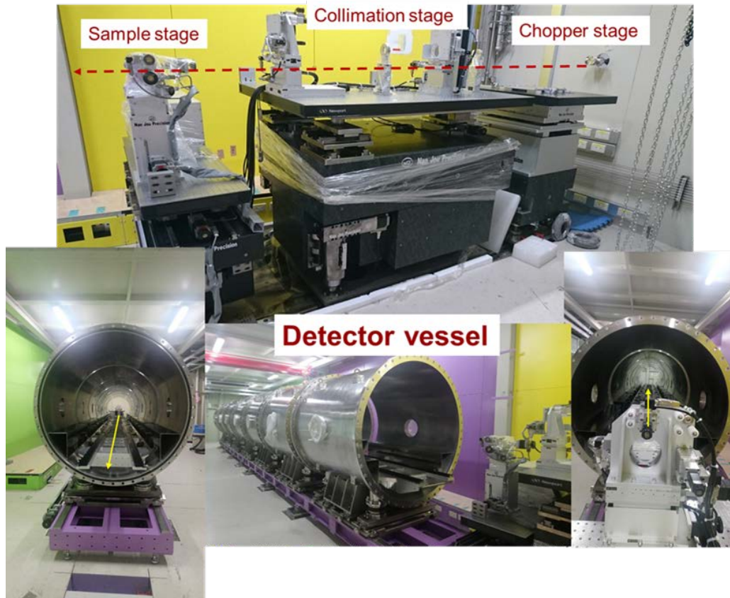
圖 2.44：13A BioSAXS 實驗站砍光器（chopper）平台、準直桌（collimation）平台、樣品平台，以及承載兩座 X 光偵檢器的大型真空腔體（下排）
