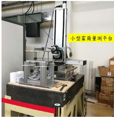
圖 2.18：利用小型霍爾量測平台，進行國內自製小型永久磁石磁場量測與驗證
