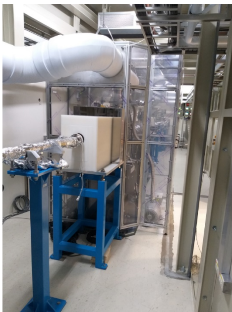
圖 2.40：07A1 光學輻射屏蔽屋內所有的光束線元件安裝貫通一覽
