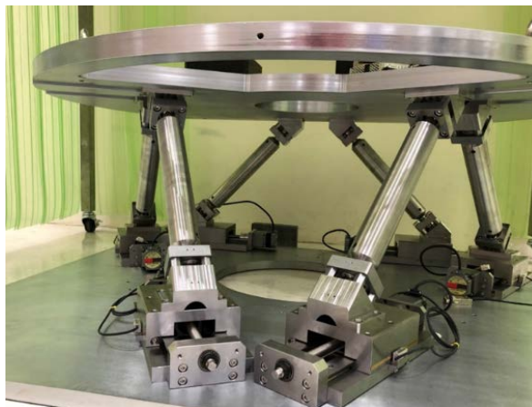
圖 2.47：超高鋼型旋轉平移系統
