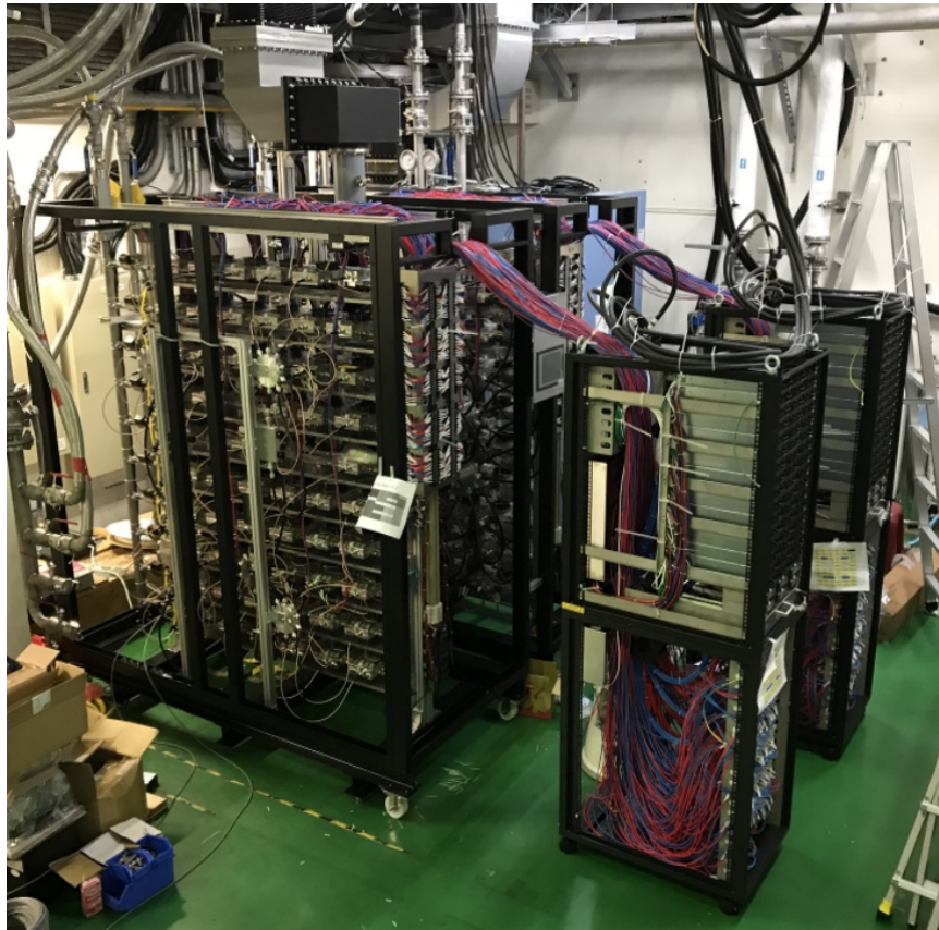
圖 2.13：500 MHz 80kW 全固態功率發射機實體
