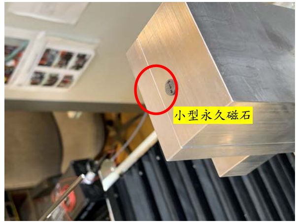
圖 2.18：利用小型霍爾量測平台，進行國內自製小型永久磁石磁場量測與驗證
