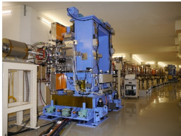
圖 2.27：低溫永磁聚頻磁鐵安裝於 TPS 儲存環
