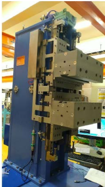
圖 2.34：完成 W100 增頻磁鐵機械框架 C-frame 與控制箱組裝
