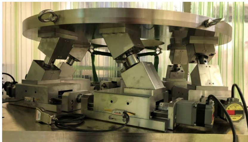
圖 2.56：超高真空旋轉平移台
