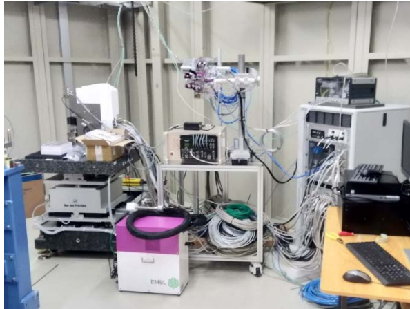
圖 2.26：MD3UP 微米單晶繞射儀之調整桌
