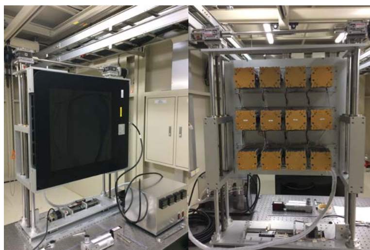
圖 2.33：二維偵檢器(XRD 1611)與致冷晶片降溫設備(左)正面;(右)背面
