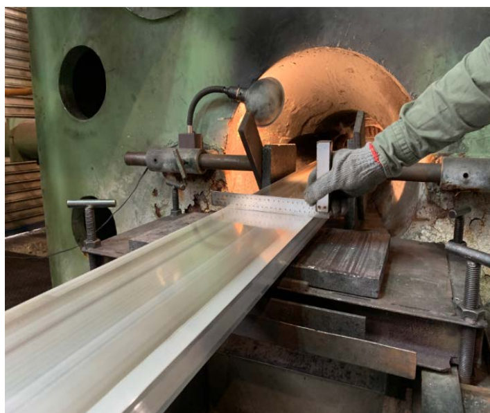
圖 2.16：長跨距之橢圓聚頻插件磁鐵用鋁合金真空腔體擠製製程
