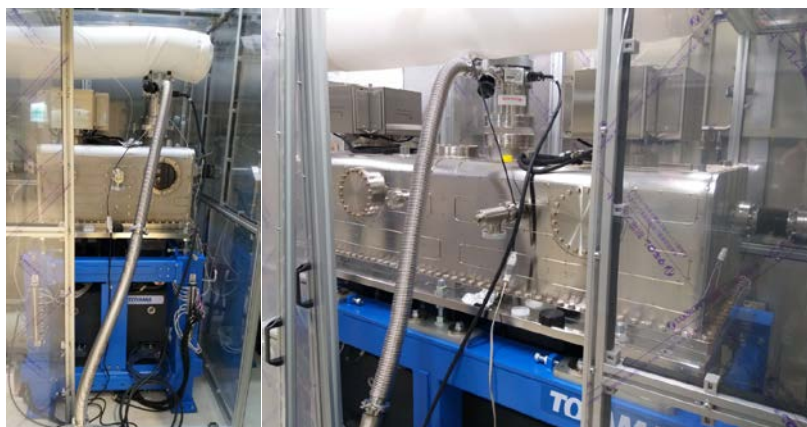
圖 2.39：07A1 溫度控制罩裡的 X 光聚光鏡箱
