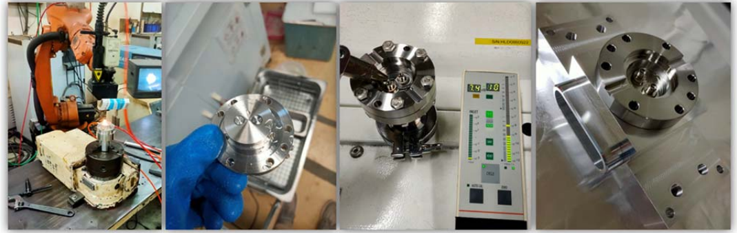
BPM 法蘭製備，依序為雷射銲接、真空清洗、真空測漏與套合測試
