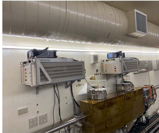
雙開關增能環引出固態脈衝電源系統安裝試車完成
