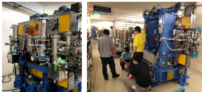
CUT18 真空元件組裝完成(左)、於 TPS 儲存環 SR08 段進行安裝作業(右)
