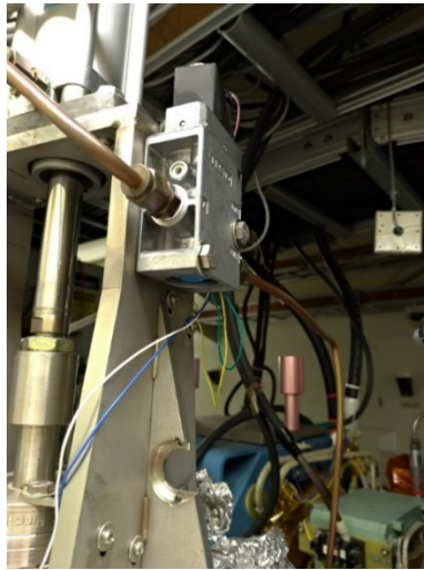
TLS 前端區 FE20 HMS 電磁閥更換
