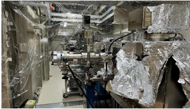
圖一、完成鏡面安裝的鏡箱，進行真空烘烤中
