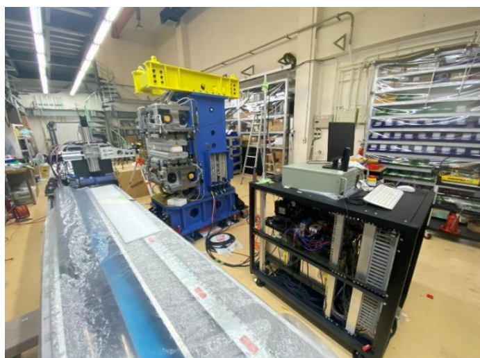
圖十二、EPU 控制器與量測系統整合
