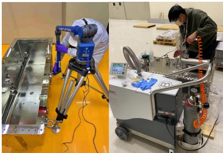
圖十七、PGM 腔體尺寸量測(左) PGM 腔體測漏(右)
