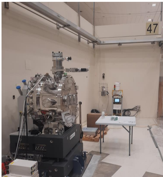
圖二十、TPS 47A DCM/DMM 安裝後現場圖
