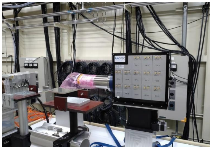
圖二十二、13-ch SDD 高螢光偵測率偵測器已安裝於 X 光吸收實驗站 XAS
