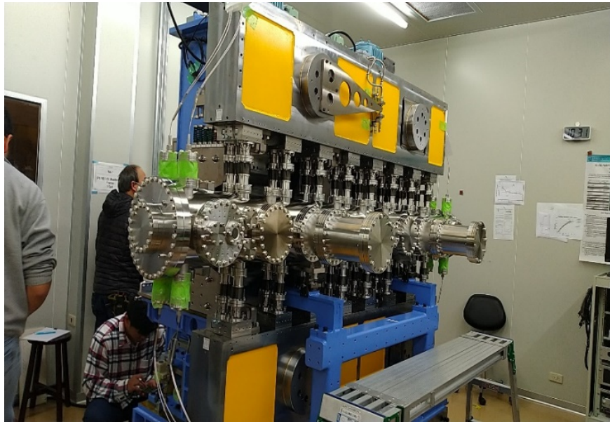
圖 2.66：CUT18 磁鐵搬至實驗室準備進行驗收及磁場量測與修正
