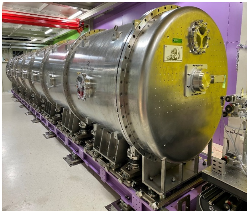
圖 2.76: 完成建置實驗站內超大型二維 X 光偵檢器之真空腔體
