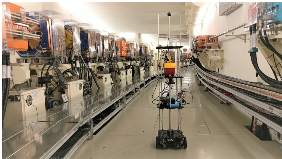
圖 2.49：中心自行開發之加速器高輻射場內自走車
