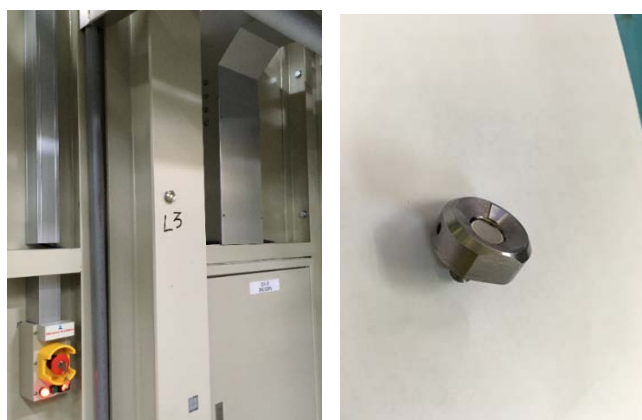
圖 2.40：自行製作螺牙球座，用於簡易增設於 hutch 內柱位控制點
