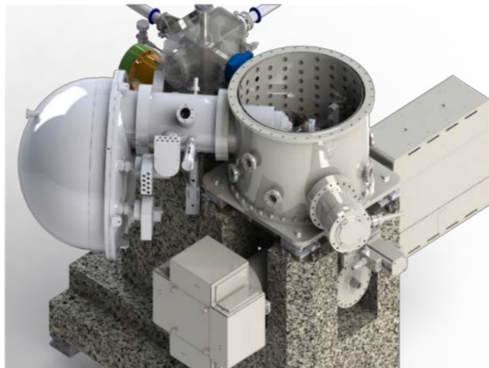
圖 2.85：奈米分支實驗站大理石基座與調整機構設計
