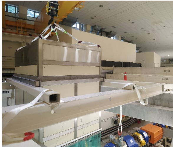
圖 2.23：TPS 隧道內現場更換高功率耦合器用的 class100 無塵室
