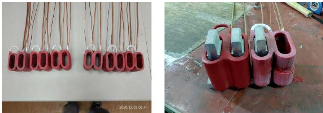
圖 2.32：快速偏振光轉換插件磁鐵線圈試製
