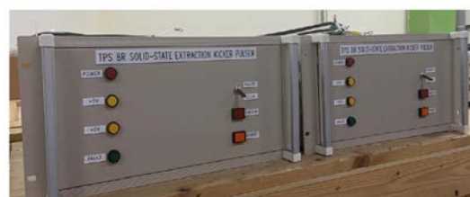
圖 2.44：TPS BR -Twin-Switch-Solid-State-EXT-KICKER-Pulser 開發成果
