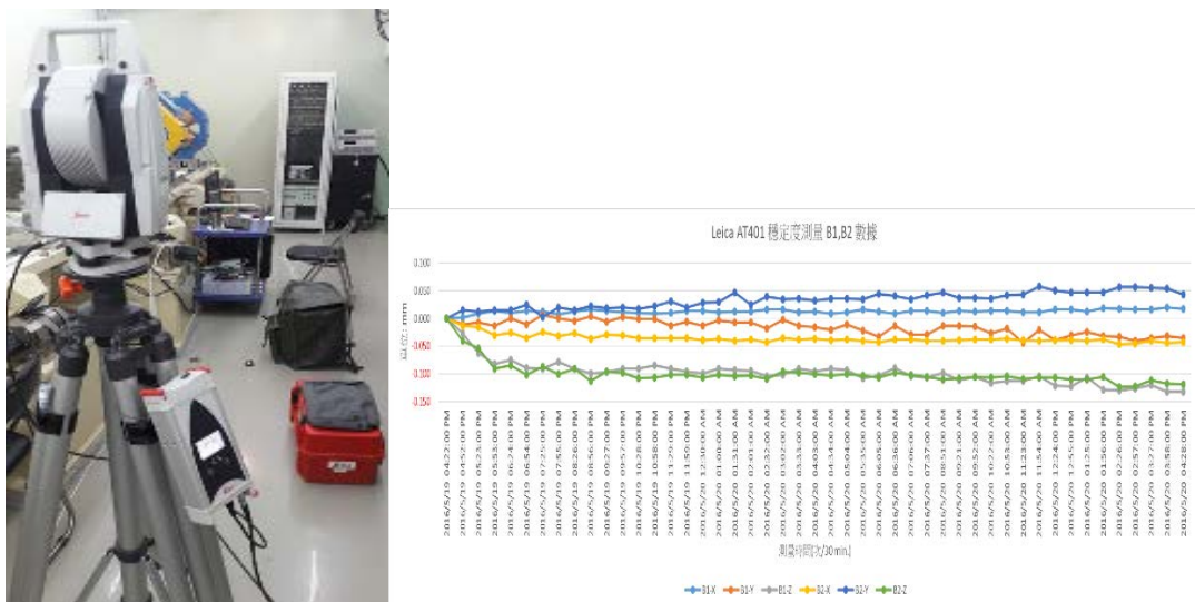
圖 2.10：自動量測系統用於長時間檢測物體變化或檢測儀器身飄移情況
