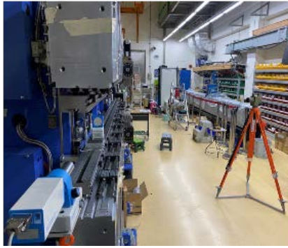
圖 2.34：於插件磁鐵實驗室完成機械精度調校與量測
