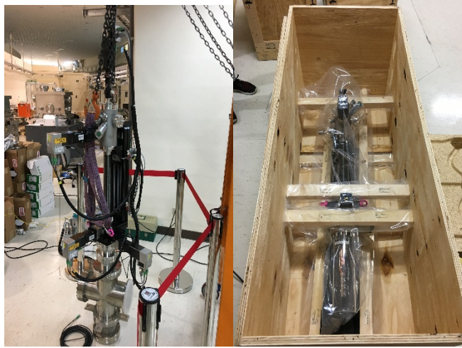
圖 2.80：測試 PRINS 實驗站樣品製備腔體之超高真空樣品操控(左)與溫控系統(右)
