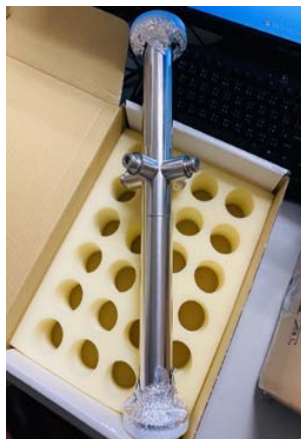
圖 2.43：注射器(左)以及 photocathode gun(右)出口端所需之 strip-line BPM
