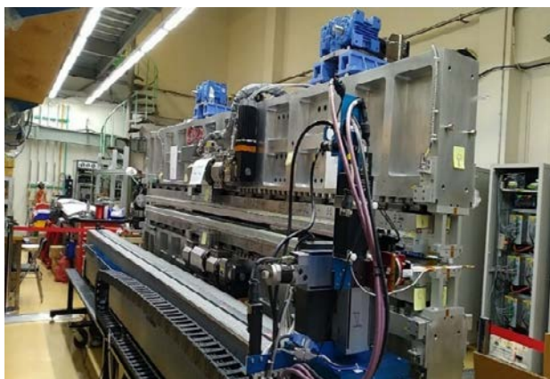
圖 2.78：EPU66 在實驗室利用 Hall probe 量測系統進行磁場量測修正
