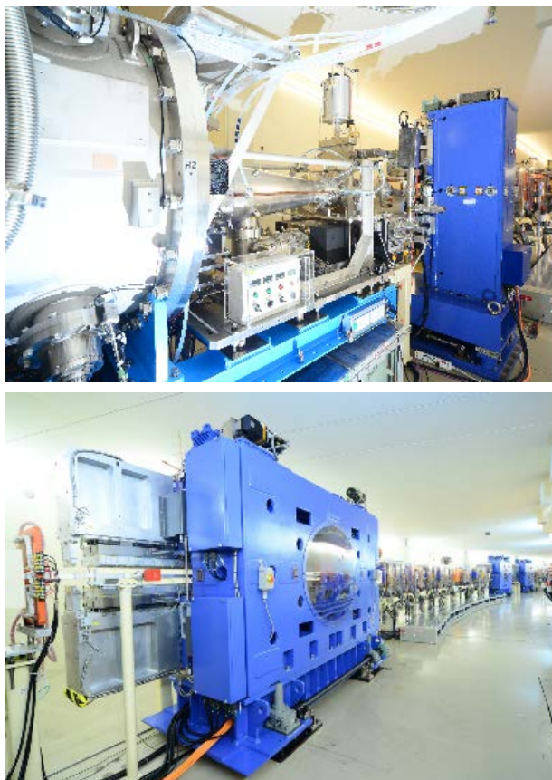
圖 2.33：(上圖)W100 安裝於 SRF 下游端；(下圖) EPU168 安裝於 TPS 短直線段
