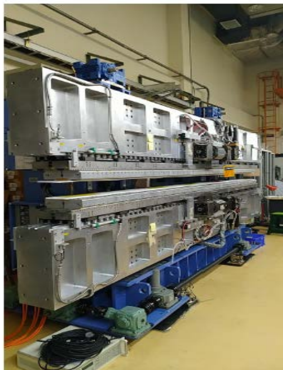
圖 2.82：EPU168 磁鐵在實驗室安裝磁極列進行測試
