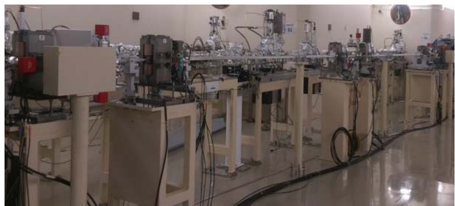
圖四十八、電子偏踢設備安裝於 TPS
