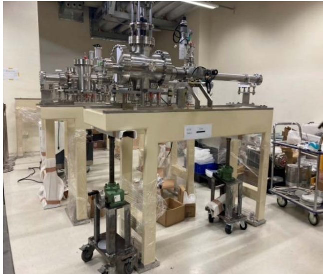
圖五十一、完成真空子系統安裝與測試
