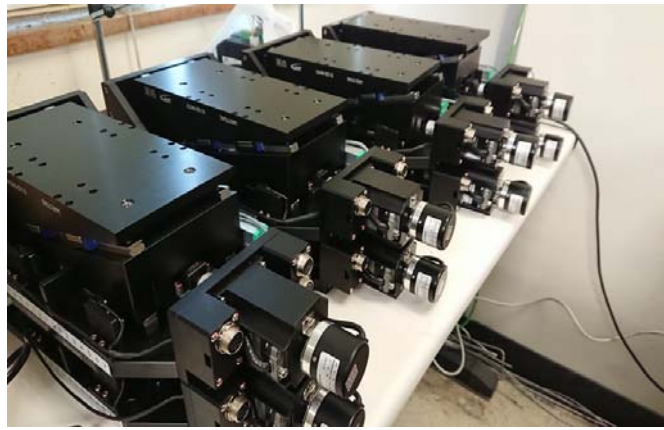
圖四十三、進行精密移動平台與執行程式測試
