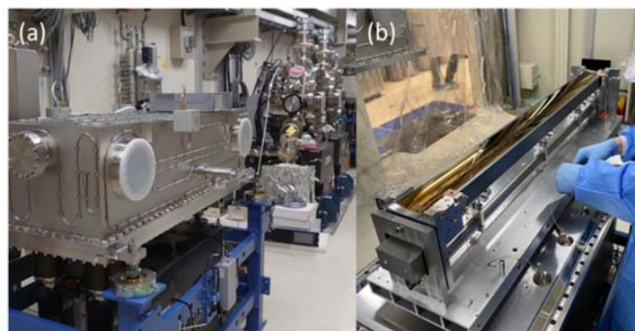
圖四十四、3 座鏡箱系統(左)以及 TFM 光學鏡(右)現場安裝
