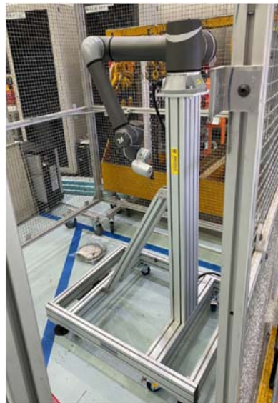
圖三十七、機器手臂完成驗收，並完成安全圍籬安裝
