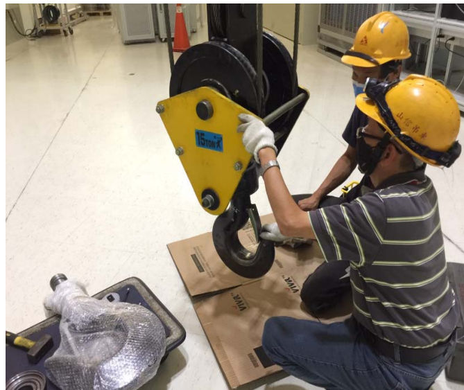
圖二十六、完成天車重型吊鉤更換
