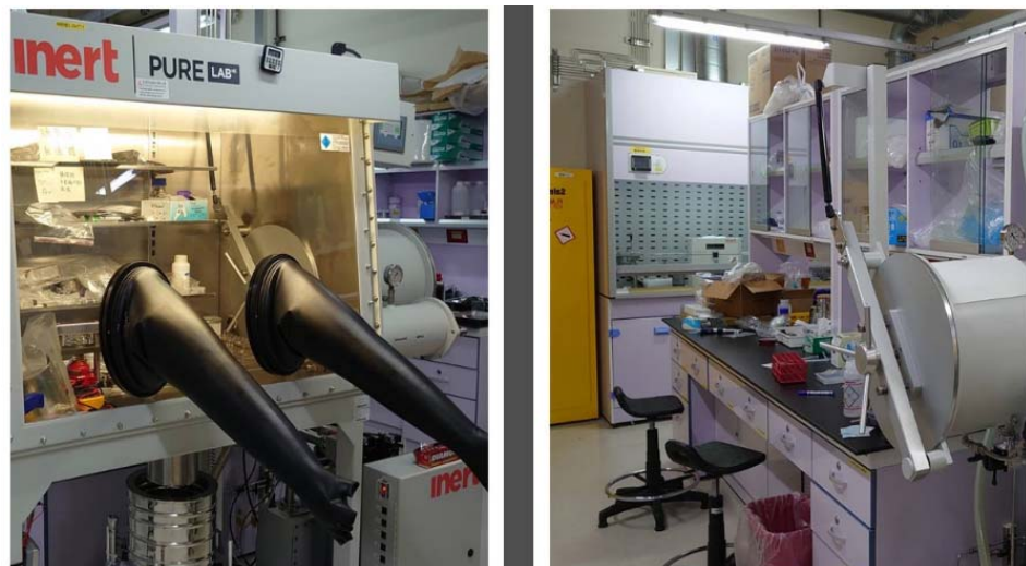
圖二十八、化學公用實驗室之手套箱、抽風櫃等設施正常運作
