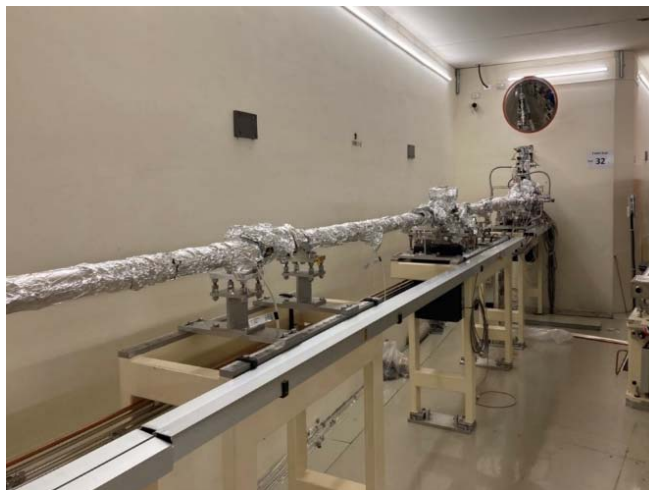
圖四十一、前端區 FE32 真空系統完成
