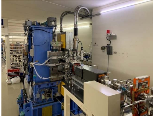
圖十一、完成 TPS SR08 CUT18 真空系統安裝
