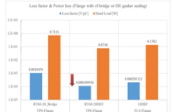
圖二十二、設計極低阻抗真空腔法蘭鋁菱形墊圈(DE-Gasket)密封結構
