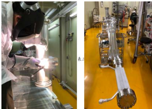
圖十三、完成 TPS SR22 段鋁合金轉彎真空腔銲接
