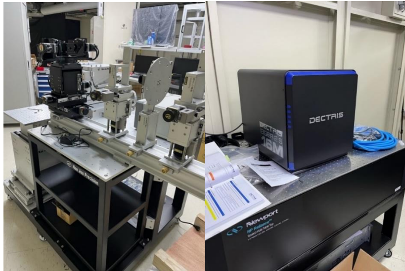
組裝完成的X光控制系統。 Eiger2 S 16M 大型二維偵檢器。
