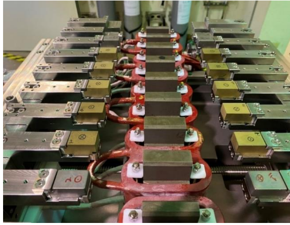
圖二、永久磁石結合電磁鐵的創新磁鐵結構
