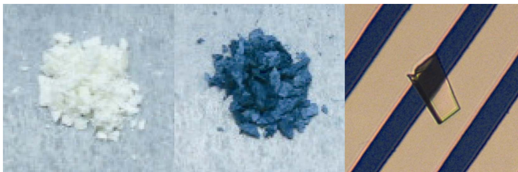
圖四 (左) 稠六苯的前驅物，(中) 加熱後產製的稠六苯，(右) 稠六苯單晶
