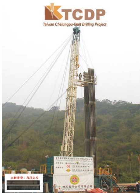
圖一 台灣車籠埔斷層 2 公里深井鑽探計畫 (TCDP)，深入地下，採集九二一地震斷層的岩心，探討車籠埔斷層巨量滑動的原因。（地點：台中大坑）
