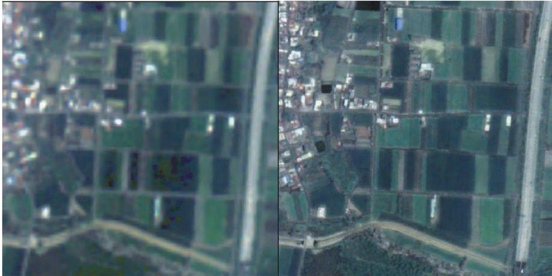
圖四 F-2 AIPS SSIM 彩色融合處理之實例。(a) 8 米解析度自然色影像(94/4/18)；(b) 2 米解析度 SSIM 彩色融合影像(94/4/18)
