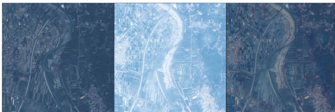
圖三 F-2 AIPS 多期影像輻亮度正規化處理之實例。(a)基底影像(93/12/17)；(b)輻射校正前影像(94/4/18)；(c)輻射校正後影像(94/4/18) (所有影像 DN 值均未增場)
