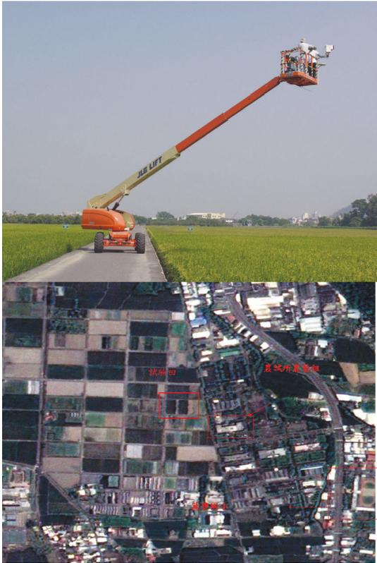
圖九 應用 F-2 AIPS 於監測水稻生長與預測產量之應用[16]。(a)使用高空作業車量測水稻田地表反射頻譜資訊之作業情形，(b)應用 F-2 AIPS 處理福衛二號於臺中縣霧峰鄉農委會農業試驗所農場所拍攝影像，所得之彩色融合正射影像
